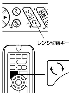
[◎] キーをレンジ切替として設定しておくと、よく使うレンジをワンタッチで切り替えることができます。レンジは 2 つまで設定でき、[◎] キーを押して切り替えます。
