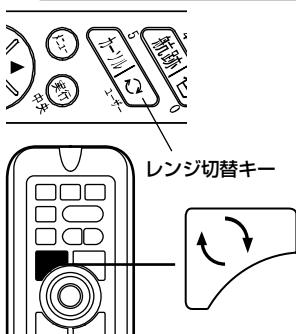
[①] キーをノースアップ/コースアップとして設定しておくと、ワンタッチで表示方向を切り替えることができます。
