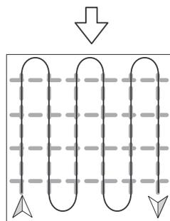
次に先程に対して直角の向きで図のよう縦方向に等間隔で走行すると、きれいなデータが得られます。
