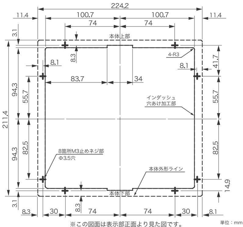
**2** 本体に止めネジM3×30を8本インダッシュ用取付ネジ穴に固定します。
