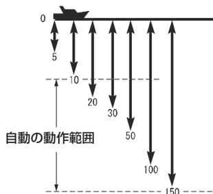
※「自動」の場合は、測定したデータの最大深度に応じて 10・20・50・100m・150m の中から最適なものが選択されます。
