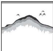
画像が薄れて魚群の判別がしにくくなり小さな魚群の反応が消えてしまいます。また深度表示が正常に動作しなくなる恐れがあります。
