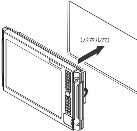
**5** 4×30 タッピングネジを挿入してパネルに固定します。(4ヶ所)
