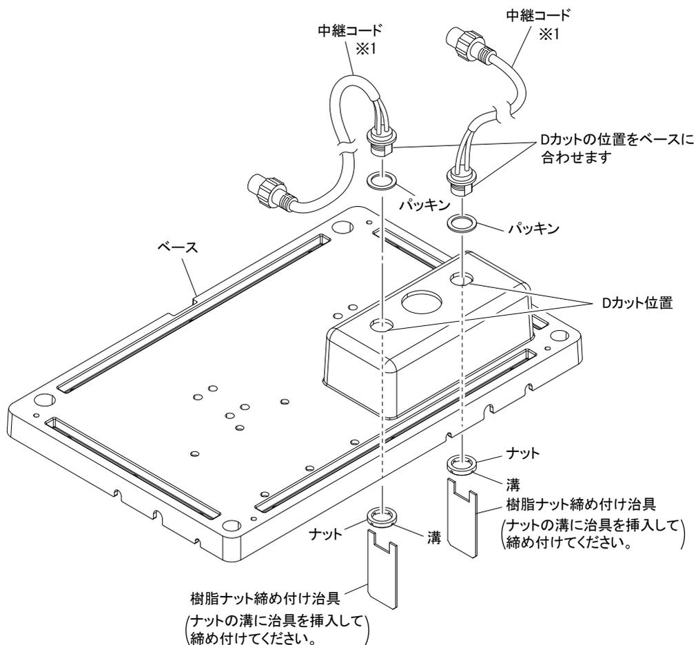
※1 電源及び振動子中継コードの取付位置は取り付ける機種の種類、電源及び振動子コンセントの場所を考慮して選択してください。
