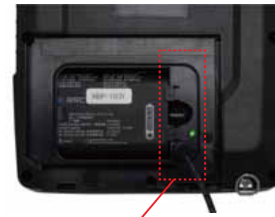
ACアダプタを本体に接続し、バッテリーを充電します。
